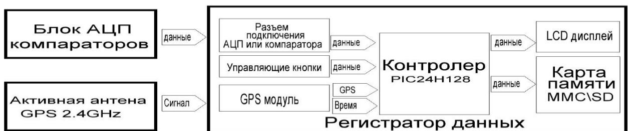
**Рис. 1. Блок схема регистратора данных**
